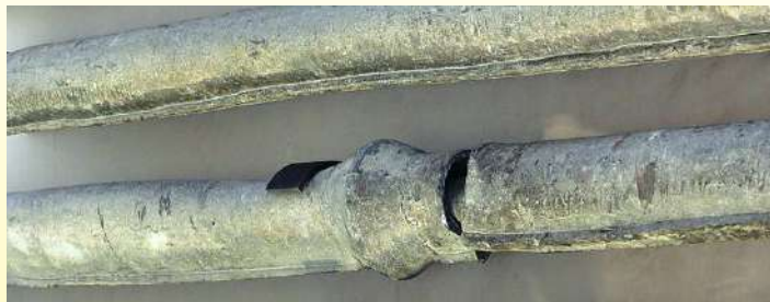
Tuyau romain en plomb soudé, fait de bandes soudées (Musée de l'Arles et de la Provence antique)
